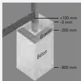
Pré-percer les trous destinés à la fixation sur la plaque de support dans le poteau (75 x 850 mm). Fixer la plaque de support au poteau ovale avec des vis (3 vis de fixation M8 x 80 mm). Fixer la plaque de support avec le poteau sur la fondation en utilisant un système d'encrage approprié. Tous les poteaux doivent être parfaitement verticaux.
